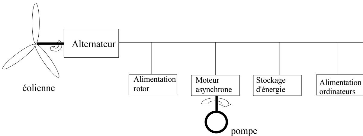
Les pales de l'éolienne entraînent le rotor d'un alternateur triphasé qui alimente un réseau électrique 400 V sur lequel sont branchés :
